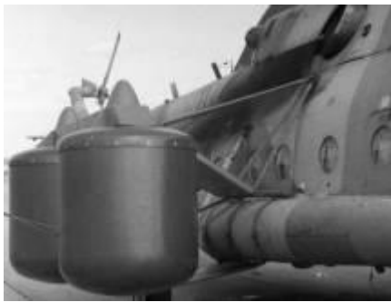
Detaily nesených bočních kontejnerů s průzkumnou technikou na Mi-17Z-2
